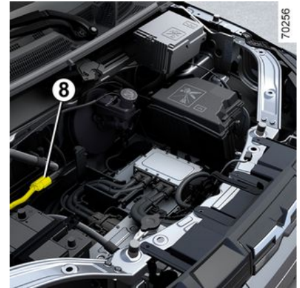
מעגל חשמלי של « 260 וולט » מסומן בעזרת כבלים כתומים 8 ועל החלקים מופיע הסמל
