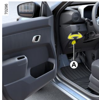
Regulacja ustawienia reflektorów:
