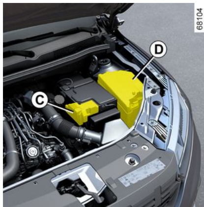
Предпазители в двигателното отделение C и D
