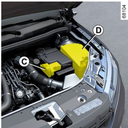
C és D biztosítékok a motortérben
