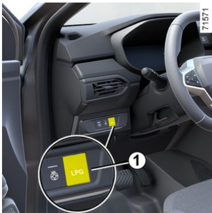
Контролен елемент за избор на режим на гориво – ВНГ/бензин 1
