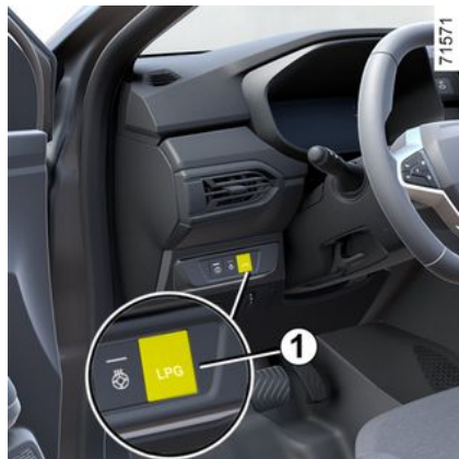
Mando de selección del modo de carburante GPL/gasolina 1
