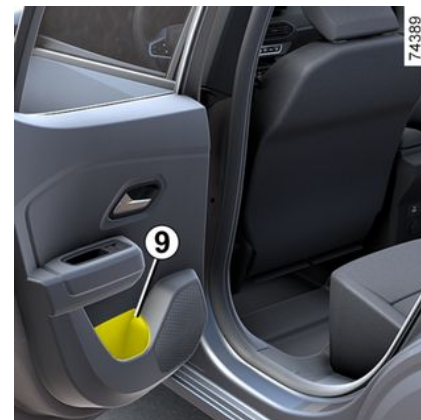
Compartimente de depozitare uși spate 9
