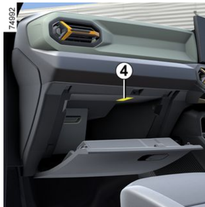
Cimdu nodaļējuma apgaismojums 4
