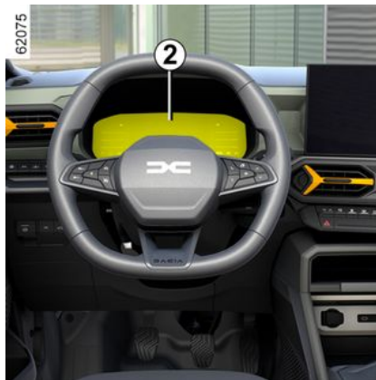
Nestekaasun määrän merkkivalo ja varoitusvalo
