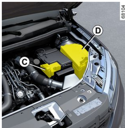
Предпазители в двигателното отделение C и D
