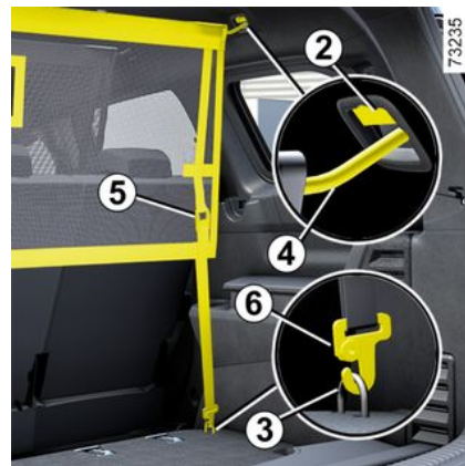
Suojaverkon asettaminen toisen takaistuinrivin taakse
