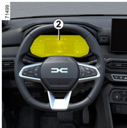
Индикатор за нивото на LPG горивото и предупредителна светлина
