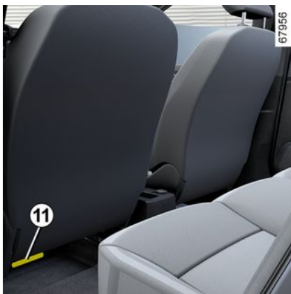
Sorties chauffage pieds des occupants 11 .
