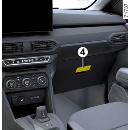
יש למשוך את הידית 4 כדי לפתוח אותו. ניתן להשתמש בתא הכפפות כדי לאחסן מסמכים בגודל A4. המכסה מאפשר אחסון של עטים, מפות וכו'.
