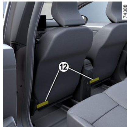
פתחי אוורור לחימום אזור הרגליים של הנוסעים 12.
