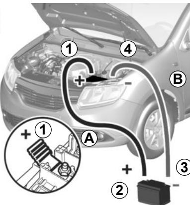
Fixe o cabo positivo (+) **A** ao borne (+) **1** da bateria desacarregada e, em seguida, ao borne (+) **2** da bateria que fornece a corrente.
